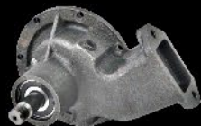
Bomba de agua
